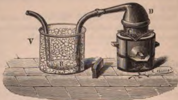
Fig. 68. — Préparation de l'acide fluorhydrique.
